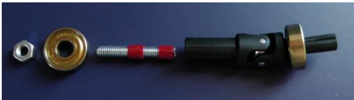
Abb. 26: Einzelteile des Universalgelenks
